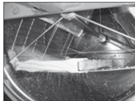
Bild 4: In der Schleuder wird der Honig aus den Waben herausgeschleudert.
